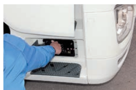
Кабина поднимается при помощи электропривода
