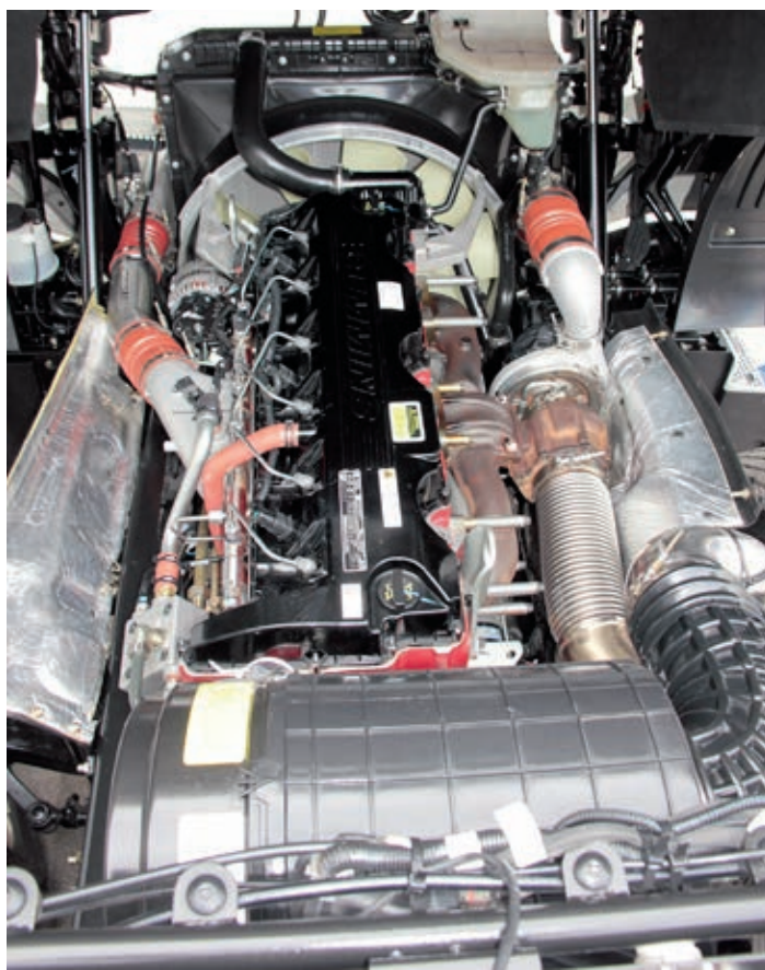
Привод насоса ГУР со стороны маховика – совсем необычно!
