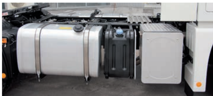
На тягаче Foton Auman EST H5 4x2 установлены два топливных алюминиевых бака объёмом 490 и 350 л. Объём резервуара под AdBlue – 65 л
