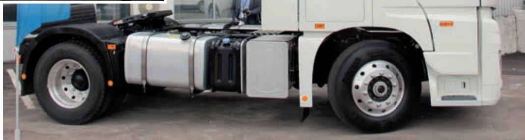
На тягаче Foton Auman EST H5 4x2 установлены два топливных алюминиевых бака объёмом 490 и 350 л. Объём резервуара под AdBlue – 65 л
